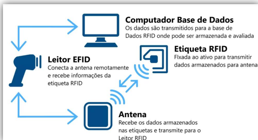
Figura 3 – Princípios de operação das etiquetas RFID
