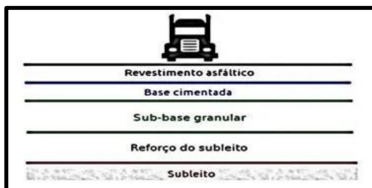
Figura 3: Seção do dimensionamento do pavimento semi-rígido
