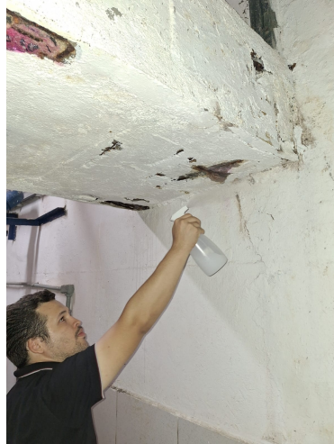
Figura 15 – Aplicação de solução de fenolftaleína no local proposto com mistura de 100 ml de água destilada para 50 ml de álcool etílico e 1 g de fenolftaleína
