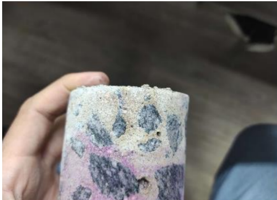
Figura 11 – Corpo de prova para identificação do grau de infiltração da carbonatação em vigas do empreendimento
