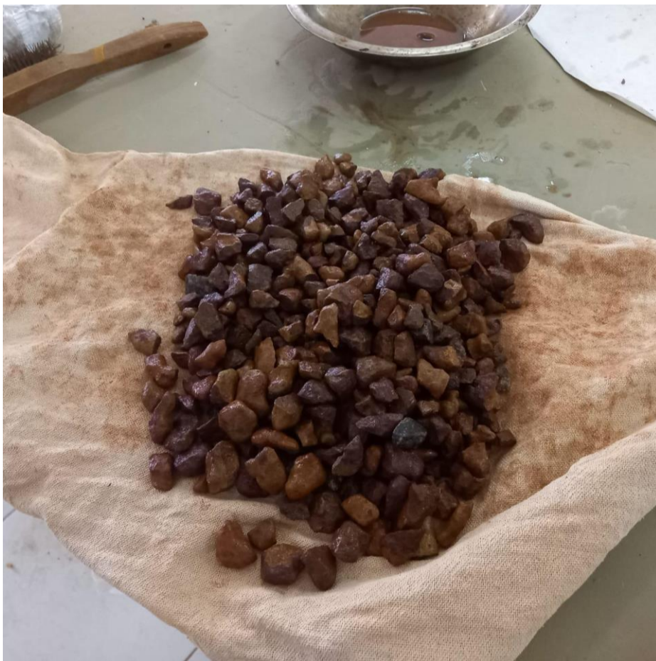
Figura 7 – agregado secado superficialmente após ser removido do tanque.
