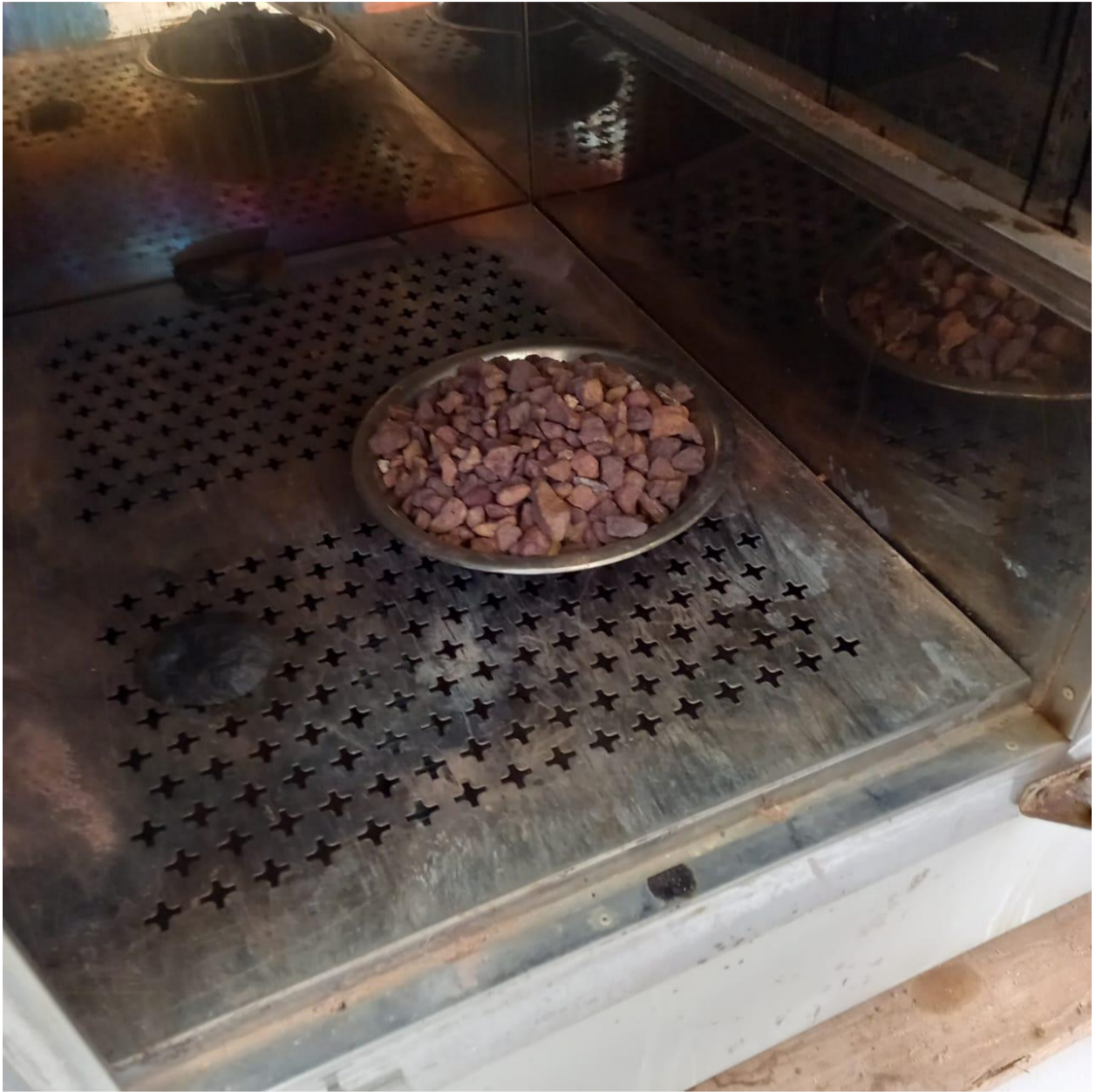
Figura 6 – agregado laterítico lavado depositado em estufa para secagem.
