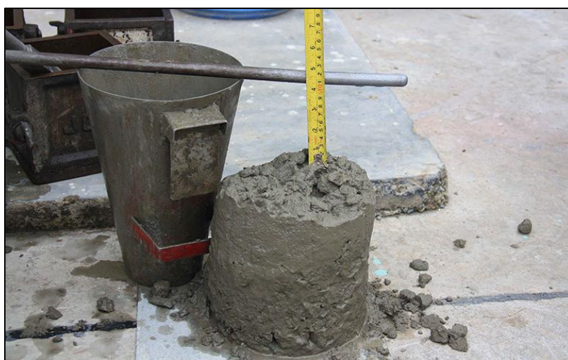
Figura 12 - Ensaio de Slump Test
