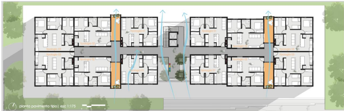
Figura 11 : Implantação e fluxos de ventilação
