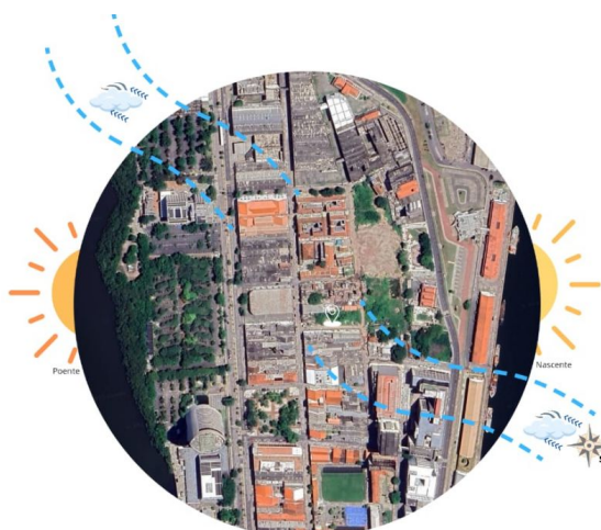
Figura 24: Ilustração de ventilação e insolação
