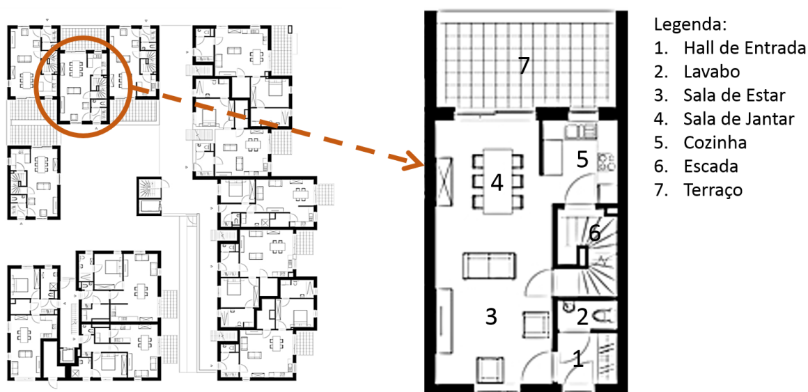
Figura 17: Planta Baixa Pavimento Térreo, Tipologia Comum B.
