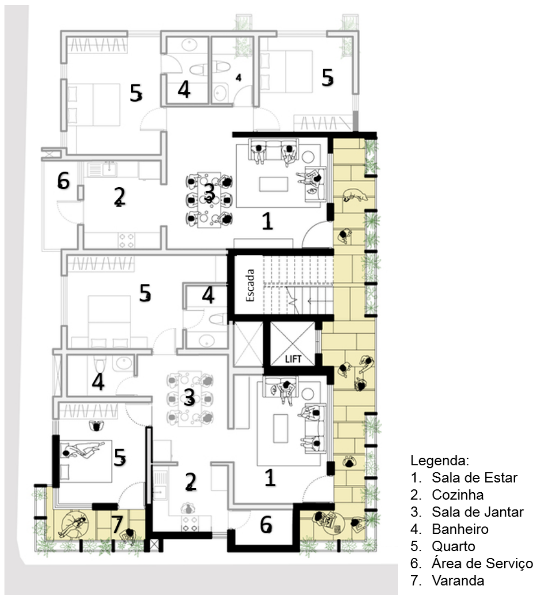
Figura 23: Planta Primeiro Pavimento.
