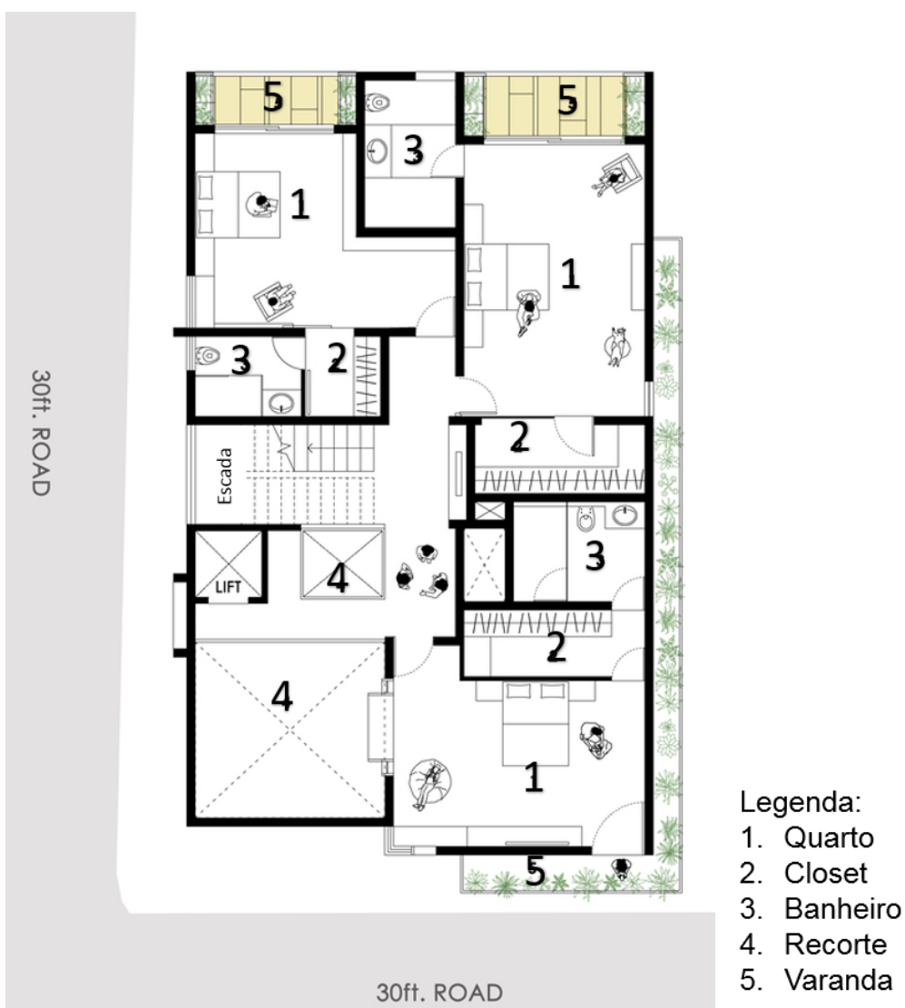
Figura 25: Planta Terceiro Pavimento Superior.
